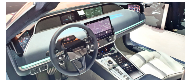
삼성전자, 디지털 콕핏 2020 - 사이드/백미러를 디스플레이로 교체하고 전면 디스플레이를 확장 및 추가한 모습이 눈에 띈다.
